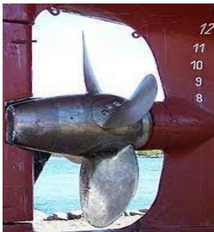
Figura 3 Hélice de passo variável, Fonte:Wikipédia.com
