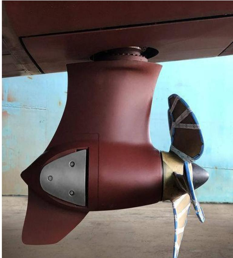
Figura 6 Propulsor azimutal, Fonte:nauticexpo.com
