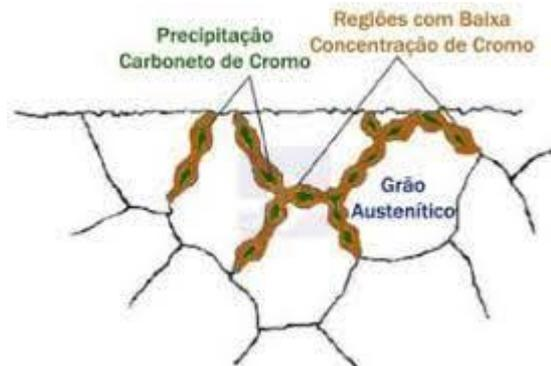
*Figura 10 Sensitização dos aços inox austeníticos por precipitação de carboneto em contorno de grãos com empobrecimento em cromo de regiões intergranulares, Fonte: MATEC*
