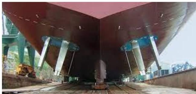
Figura 7 Propulsor cicloidal, Fonte:nauticexpo.com
