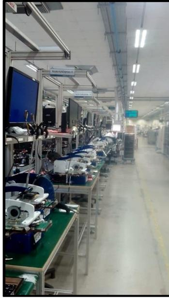
**Figura 4** – Linha de OBA com os jigs de testes automatizados
