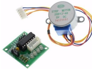
Figura 17. Motor de passo 28BYJ-48 e Driver ULN2003.
