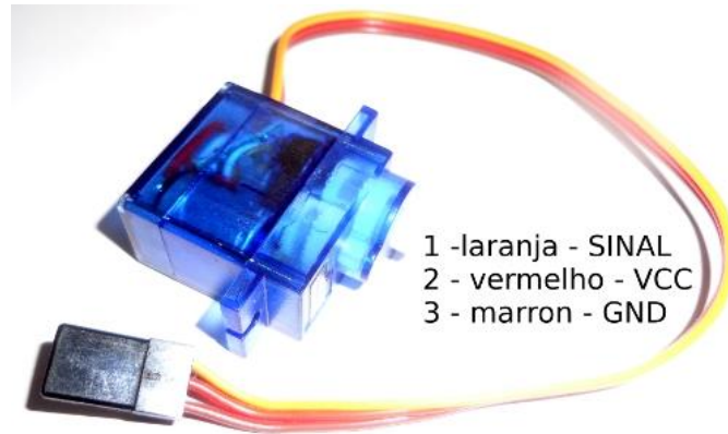
Figura 15. Indicação dos pinos de ligação do Servomotor .
