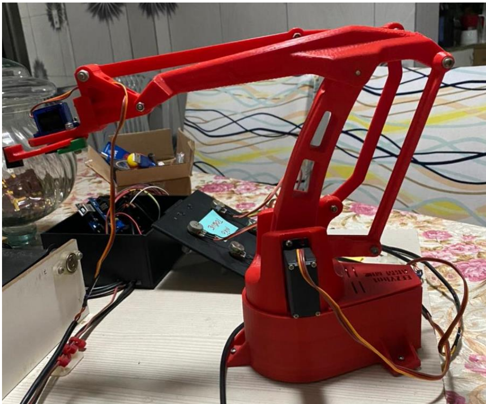
Figura 22. Braço robótico fabricado na Impressora 3D.
