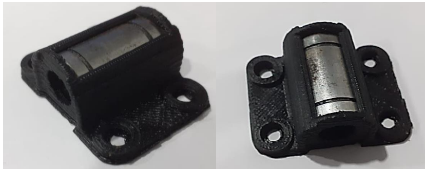
Figura 53. Suporte da Bucha - 3L PRINTER parâmetros OK
