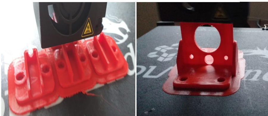
Figura 21. Impressão dos suportes da impressora 3L Printer
