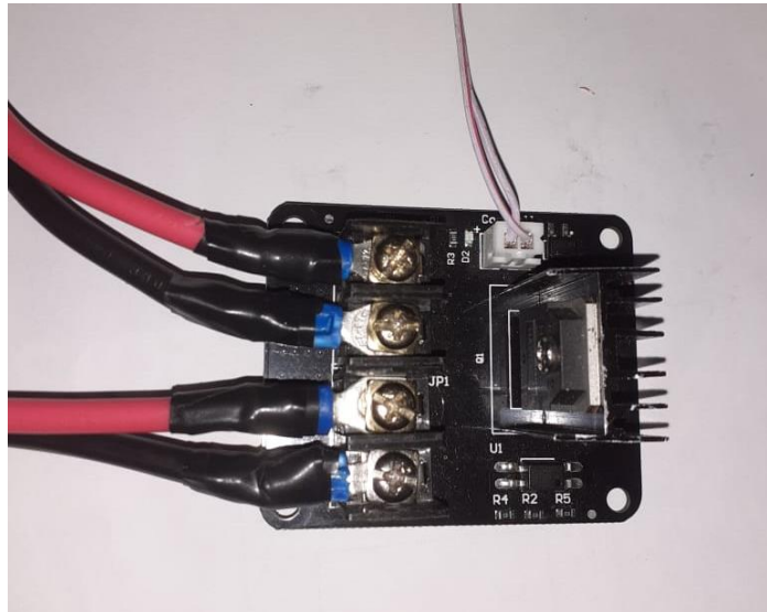
Figura 37. Mosfet módulo expensor de energia
