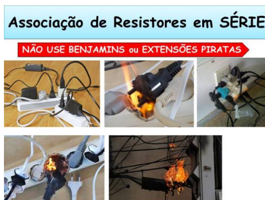
Fig.D. 26 – Alerta sobre equipamentos de qualidade duvidosa nas associações em Paralelo de Resistores - Segunda parte do SMP.
