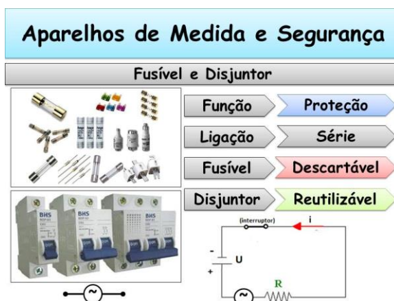
Fig.D. 30 – Resumo sobre os Fusíveis e Disjuntores - Segunda parte do SMP.
