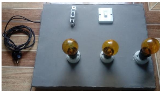
Fig.3. 1- Esquema das lâmpadas em um circuito elétrico com a associação (fiação) oculta.
