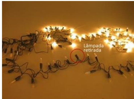
Fig.2. 23 – Luzes pisca-pisca: associação em série. Uma lâmpada foi retirada e todo o ramo em série apagou. As lâmpadas acesas representam um ramo paralelo ao anterior.
