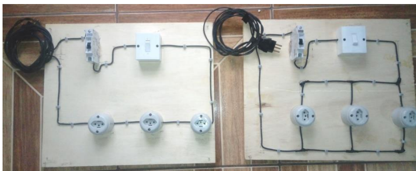
Fig.3. 2 - Visualização das fiações das associações em série (lado esquerdo) e em paralelo (lado direito).
