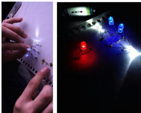
Fig.C. 2 - Circuito Misto com Curto Circuito – 3º1/Escola Y.
