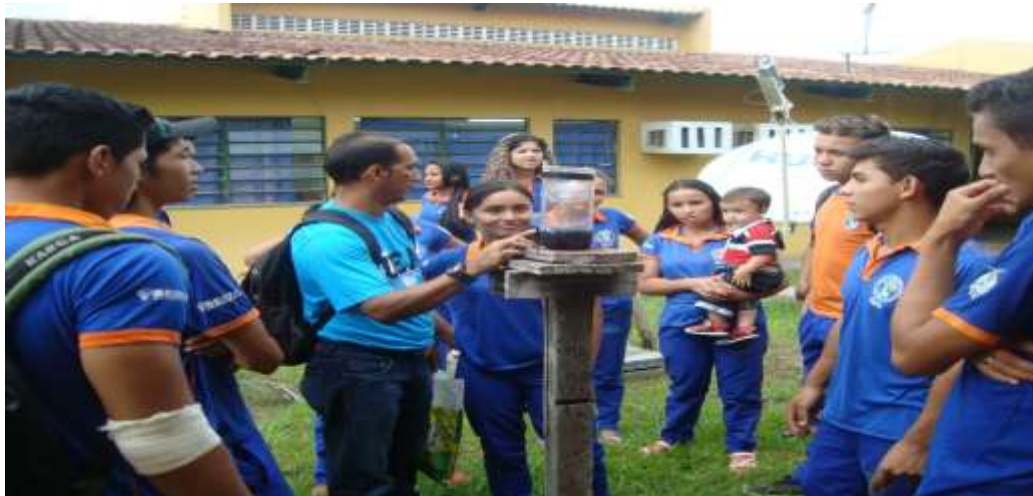
Fig.06: Pluviômetro construído pelos estudantes no pátio da escola para coleta de dados
