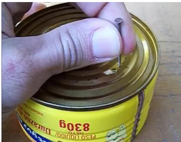
Figura 19: Furo feito com o prego e martelo no fundo do Cilindro de resfriamento.
