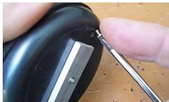
Figura 42: Colocando o parafuso no fundo da tampa do cilindro.
