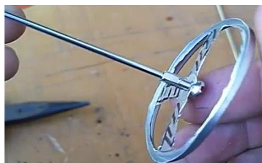
Figura 61: Fundo do pistão deslocador de ar.
