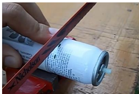
Figura 122: Cortando a lata de desodorante com a serra de ferro.
