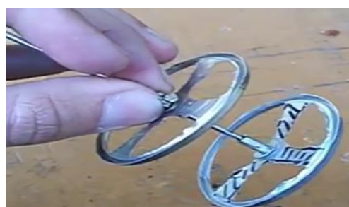
Figura 67: Forma do cilindro deslocador de ar.
