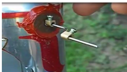
Figura 103: Encaixe do conector do fio de luz na lateral do virabrequim.
