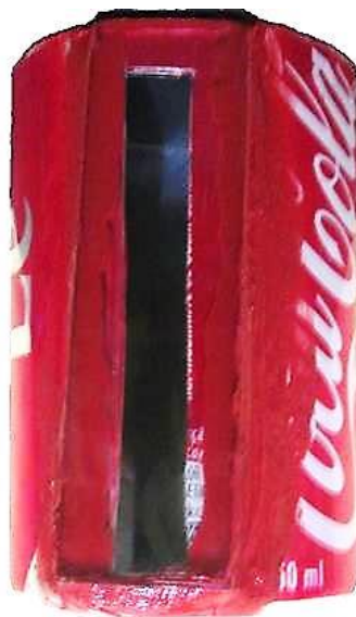
Figura 15: Cilindro quente com a lâmina onde será possível ver o êmbolo se movendo.
