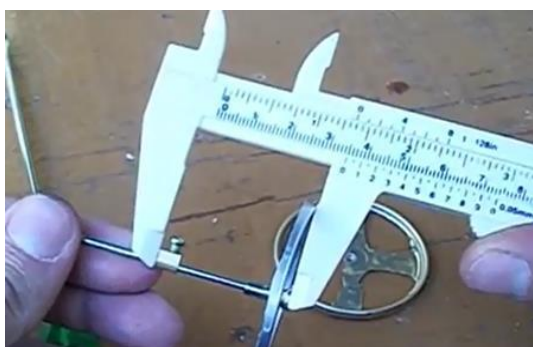
Figura 64: Medida do pistão deslocador de ar.
