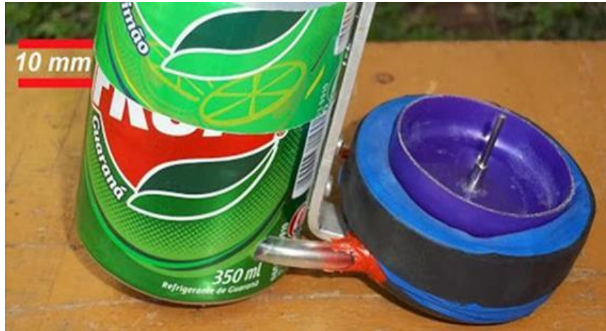
Figura 11: Cabeçotes encaixados em 1 cm.
