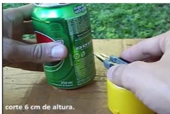
Figura 3: Corte da lata para o cabeçote com o estilete.
