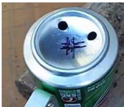
Figura 36: Localização dos furos no fundo do cabeçote.
