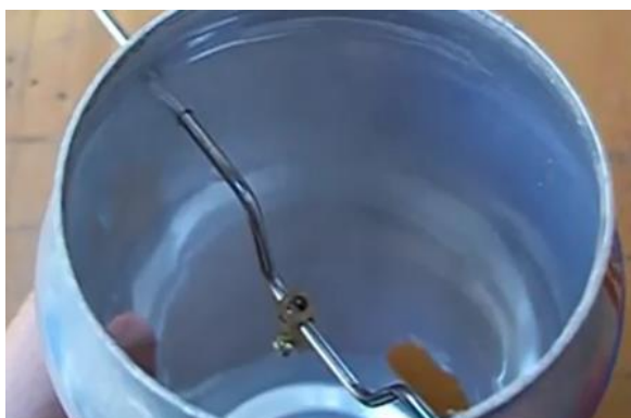
Figura 89: Virabrequim encaixado na lata de suporte.
