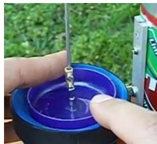
Figura 108: Alinhamento do conector do fio de luz no pistão de trabalho.
