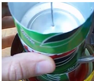
Figura 91: Encaixe do pistão deslocador de ar.
