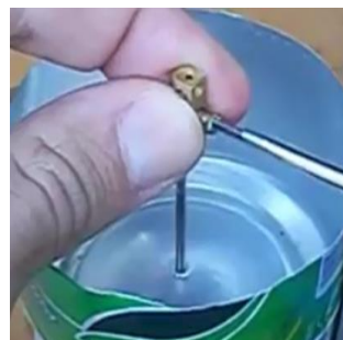
Figura 94: Encaixe do conector de fio de luz no raio do pistão.
