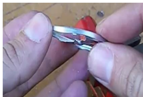
Figura 57: Corte para afinar a tampa da lata de refrigerante (57a). Espessura da tampa depois de cortada (57b).
