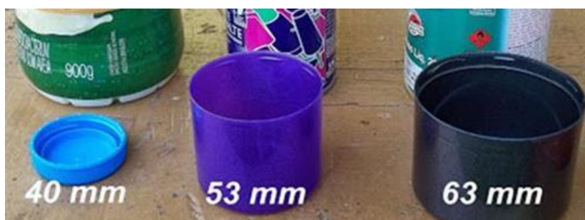
Figura 25: Tampas necessárias para o pistão de trabalho.
