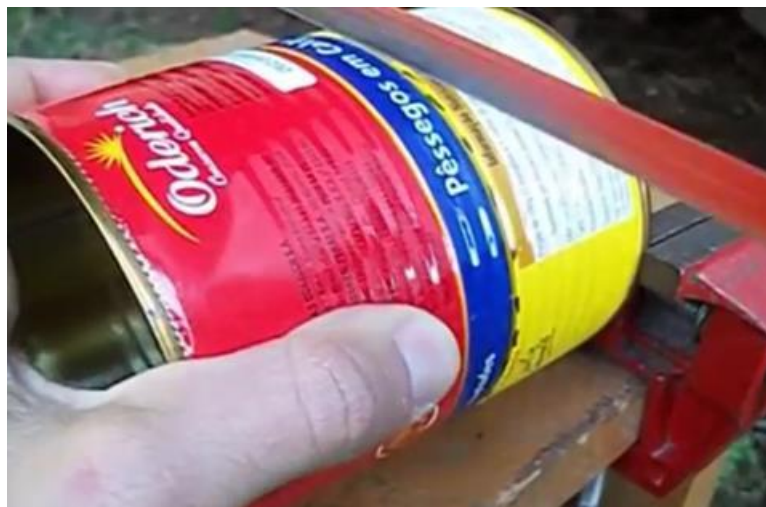
Figura 17: Corte do Cilindro de resfriamento com a serra de cortar ferro.
