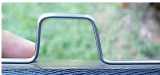
Figura 85: Teste em pé do alinhamento do raio.
