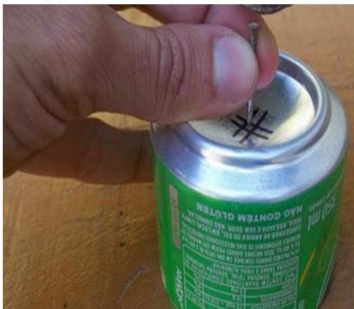
Figura 7a: Forma de fazer o furo inicial no fundo da lata antes de furar.
