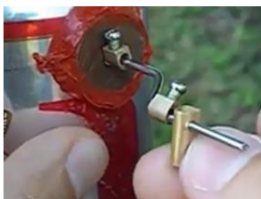
Figura 105: Encaixe do conector do fio de luz na lateral do virabrequim.
