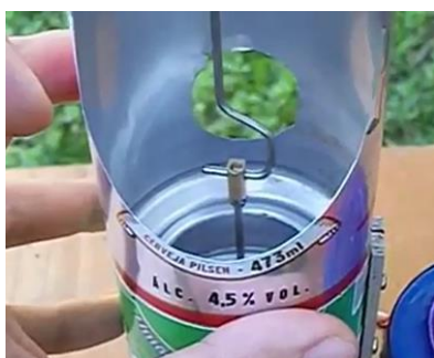
Figura 96: Encaixe do pistão ao virabrequim.
