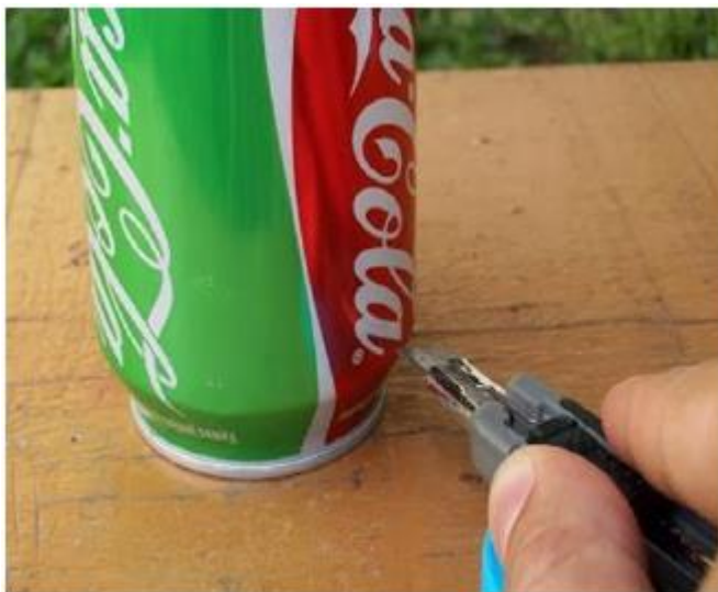
Figura 12a: Estilete apoiado para cortar a lata para o cilindro quente
