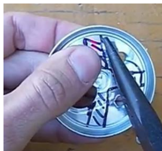
Figura 54: Recorte na tampa da lata de refrigerante.
