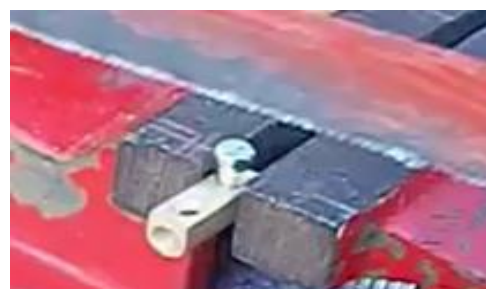
Figura 63: Forma de cortar o conector de fio de luz.
