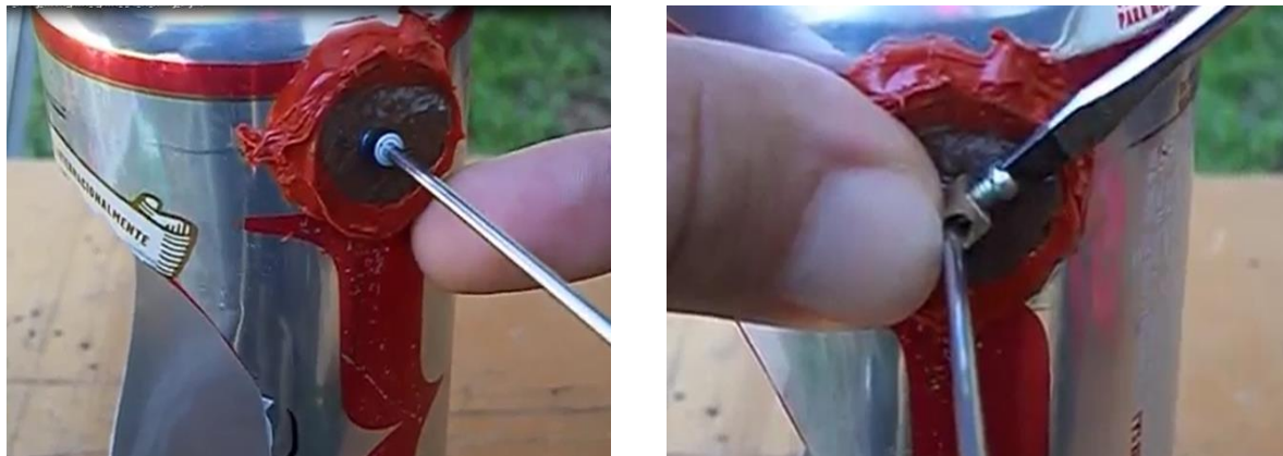
Figura 90: Virabrequim com o conector de fio de luz sendo encaixado no suporte do volante.
