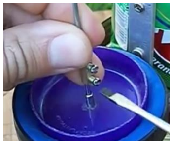
Figura 107: Encaixe do conector do fio de luz no pistão de trabalho.
