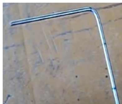
Figura 81: Formato do raio após a primeira dobra.
