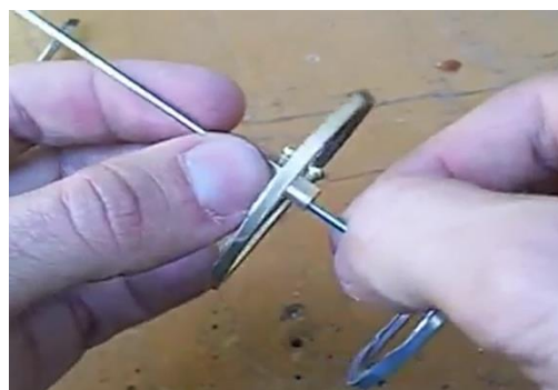
Figura 65: Modo de encaixe das tampas de suporte.
