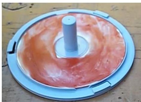
Figura 111: Colando os CDs/DVDs, alinhando com o suporte.
