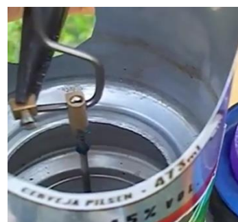
Figura 97: Fixação do pistão ao virabrequim com o conector de fio de luz.
