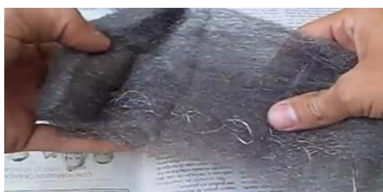
Figura 68: Desenrolando a palha de aço.
