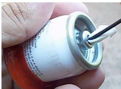
Figura 126: Encaixando o pavio na lamparina.
