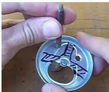
Figura 53: Furo com um prego na tampa da lata de refrigerante.
