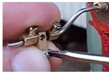
Figura 110: Encaixe do conector do fio de luz no raio do pistão de trabalho.
