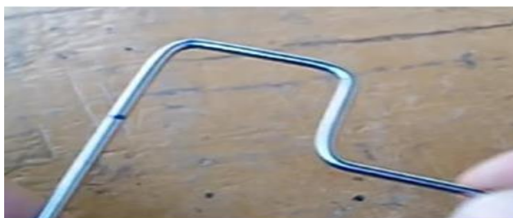
Figura 83: Formato do raio após a terceira dobra.
