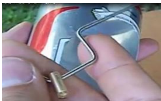
Figura 88: Virabrequim com o conector de fio de luz sendo encaixado no suporte do volante.
