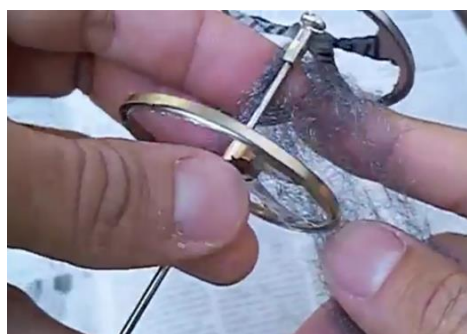
Figura 71: Enrolando a lã de aço para fazer o êmbolo do pistão.
