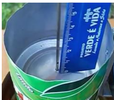
Figura 92: Medida de corte do pistão deslocador de ar.
