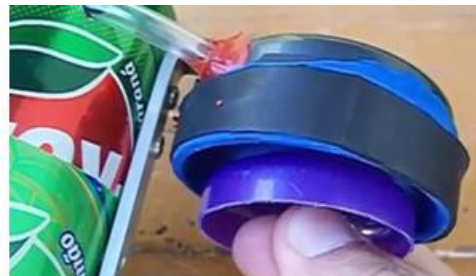
Figura 47: Puxando o pistão para verificar se não há fugas de ar.
