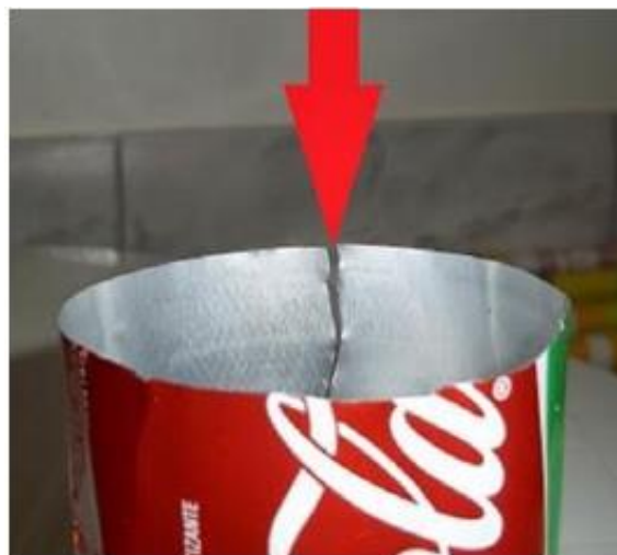
Figura 14: Rompimento do cilindro, ao encaixar o cabeçote.
