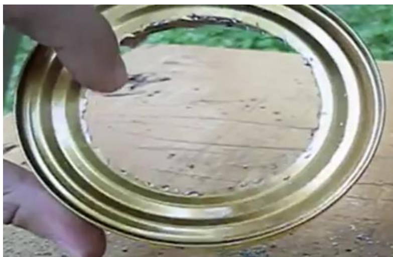
Figura 21: Fundo do Cilindro de resfriamento onde será encaixado o cilindro de aquecimento.
