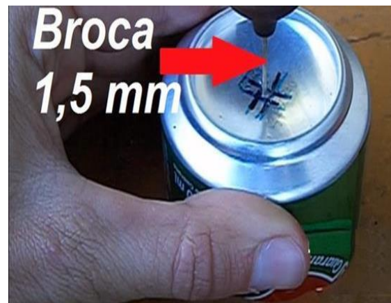
Figura 7b: Furação inicial com uma broca de 1,5 mm de diâmetro.
