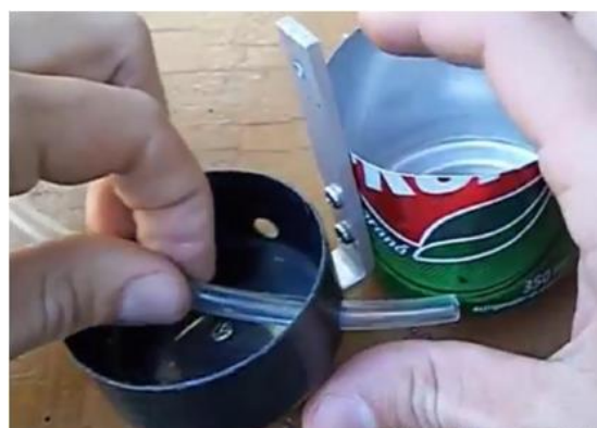
Figura 39: Marcação do cabeçote, para passar a mangueira.
