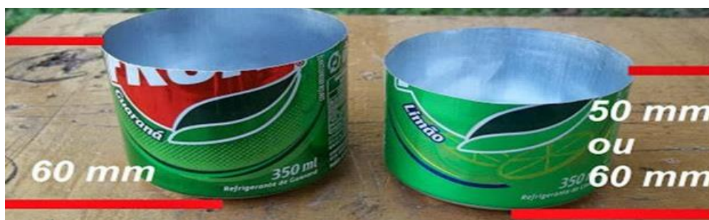
Figura 5: imagem dos dois cabeçotes cortados.
