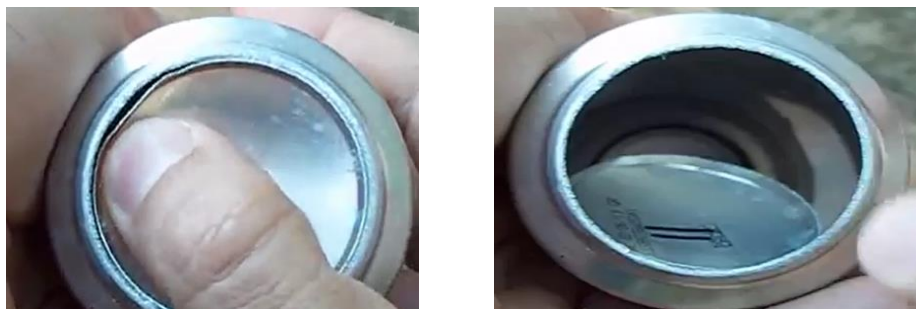
Figura 75: Forma de retirar o fundo da lata
