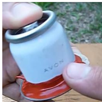
Figura 125: Colando a placa de alumínio na lamparina.
