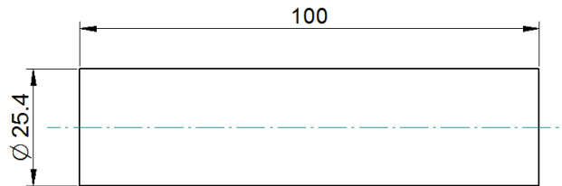
Figura 20 - Desenho dos corpos de prova utilizados- própria autora.
