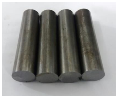
Figura 19 – Corpos de prova usados aço 1045- próprio autor
