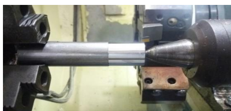
Figura 26 – Corpo de prova fixado no torno
