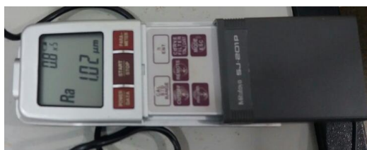
Figura 25 – Rugosímetro Mitutoyo SJ-210- Próprio autor
