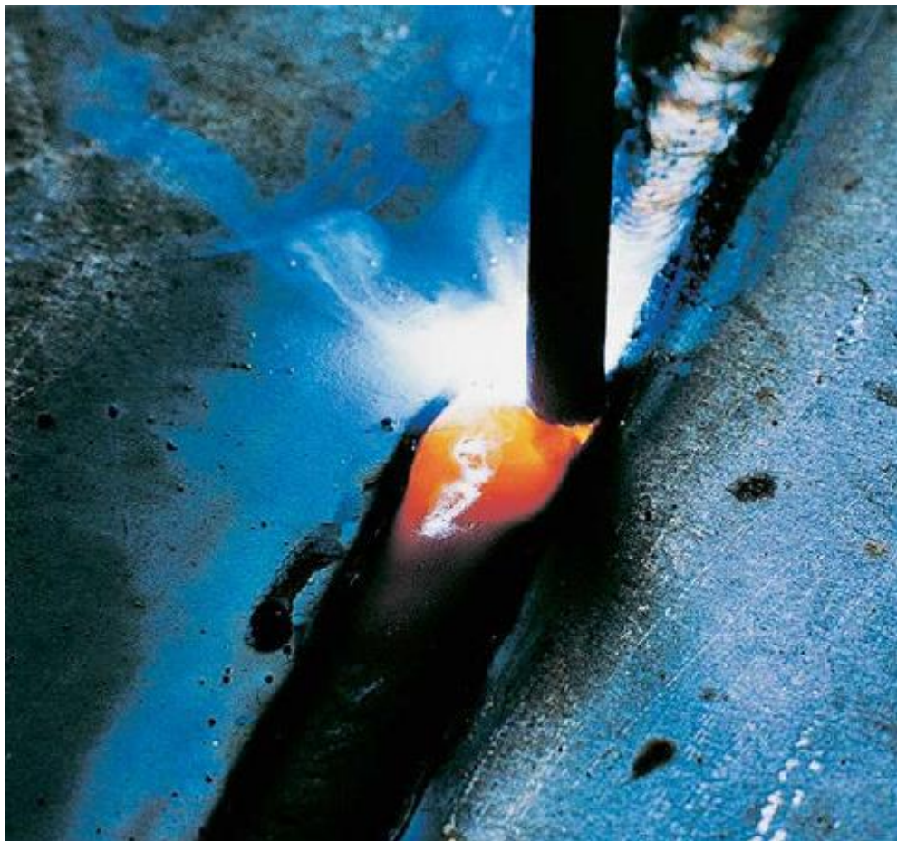
Figura 4 – Soldagem a arco elétrico com eletrodo revestido. Fonte: ESAB, 2005.
