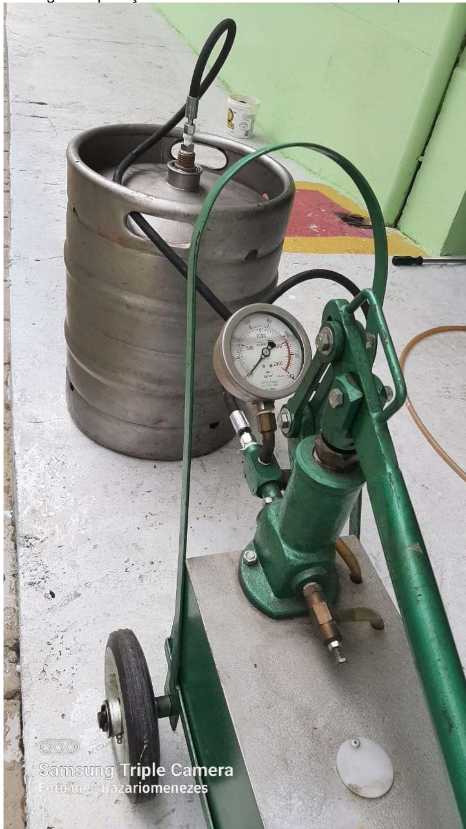
Imagem: Aplicação de teste hidrostático em vaso de pressão
