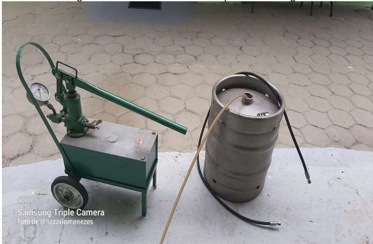
Figura: Abastecimento do vaso de pressão com água
