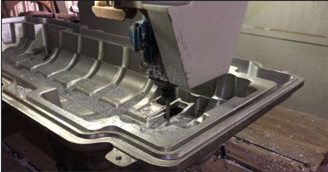
Figura 4 – Usinagem de molde metálico
