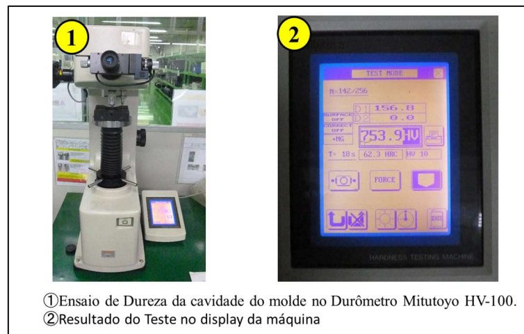
Figura 16 – Ensaio de Dureza da cavidade do molde
