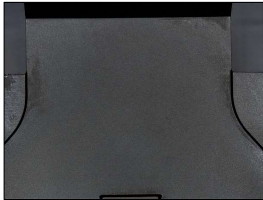
Figura 12 – Aspecto visual da superfície da cavidade nova do molde
