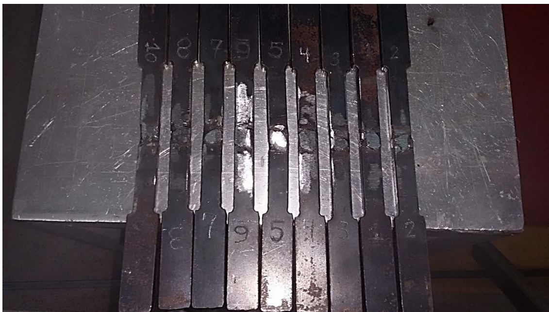
Figura 26: Corpos após o trabalho no esmeril. Fonte: Elaborada pelo autor.
