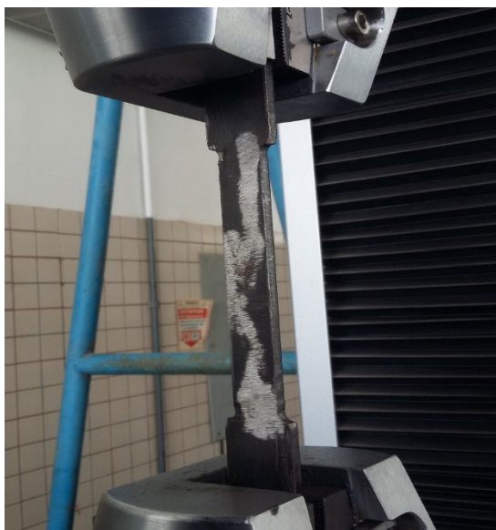
Figura 27: Corpo de prova posicionado na máquina WDW 100. Fonte: Elaborada pelo autor.
