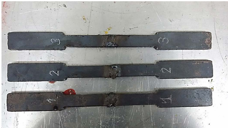
Figura 23: Corpos soldados com 75 A. Fonte: Elaborada pelo autor.
