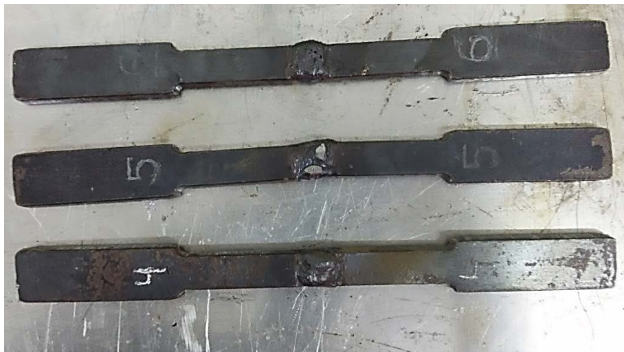
Figura 24: Corpos soldados com 125 A. Fonte: Elaborada pelo autor.
