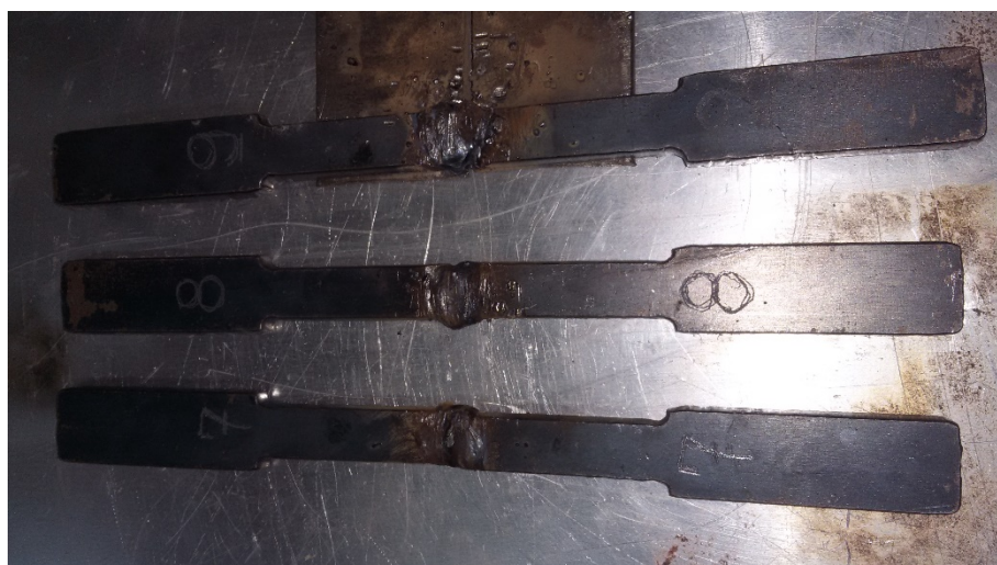
Figura 24: Corpos soldados com 125 A. Fonte: Elaborada pelo autor.
