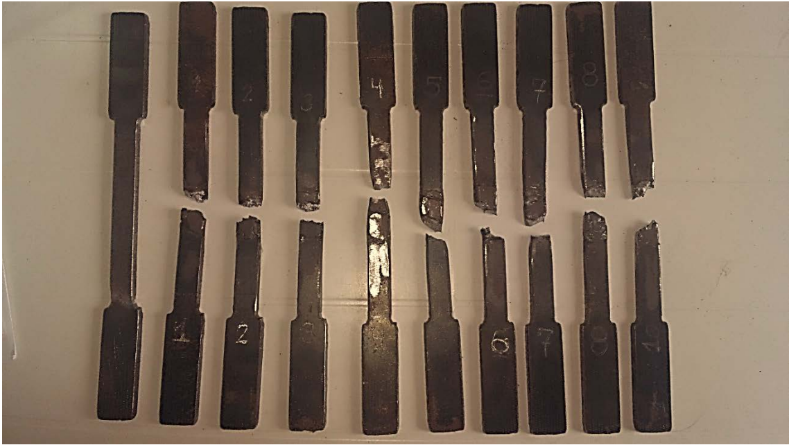
Figura 29: Corpos de prova após o ensaio de tração. Fonte: Elaborada pelo autor.
