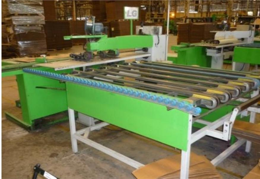
Figura 06: Visão Lateral da Máquina Grampeadeira. Fonte: International Paper (2017).
