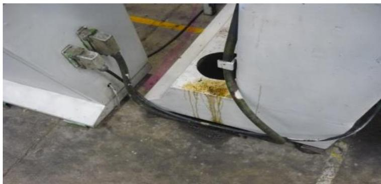
Figura 12: Fios Exposto, Vazamento de Óleo. Fonte: International Paper (2017).
