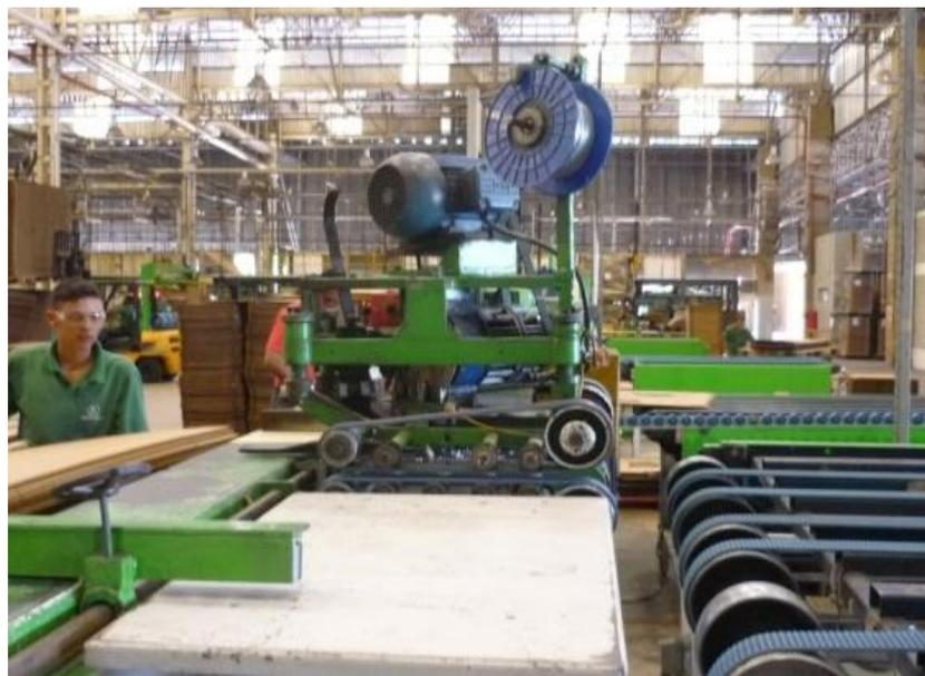
Figura 07: Visão Lateral da Máquina Grampeadeira. Fonte: International Paper (2017).
