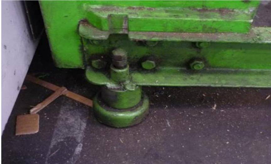
Figura 19: Base de Apoio da Máquina Grampeadeira. Fonte: International Paper (2017).
