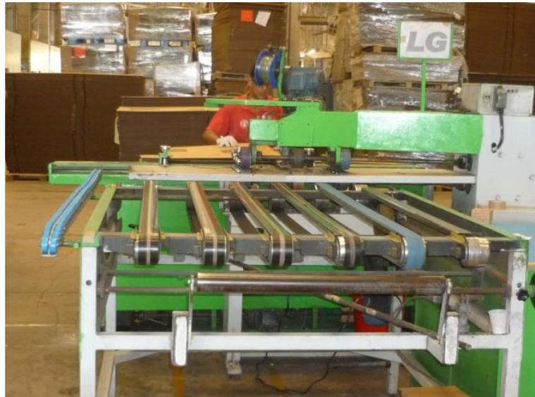
Figura 05: Visão Frontal da Máquina Grampeadeira. Fonte: International Paper (2017).
