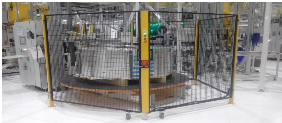
Figura 48- Sistema de Desbobinador de Formação do Anel já Enclausurado, a Partir da Mesma Aplicação Utilizar no Tombador, Carro de Transporte e Desbobinador da Prensa de Formação da Tampa Básica.
