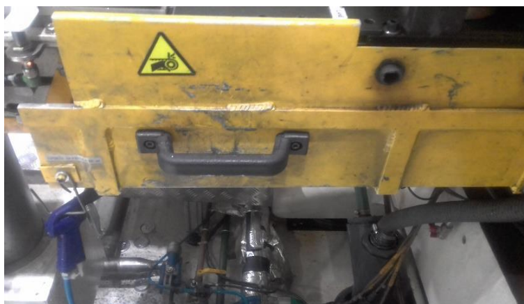
Figura 3 - Proteção Fixa de Uma Correia de Transferência
