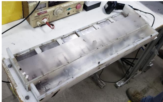
Figura 25- Antiga bancada para o ensaio com tensão aplicada
