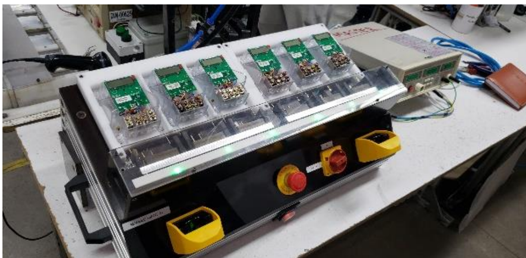
Figura 50 - Sistema de HiPOT após a montagem
