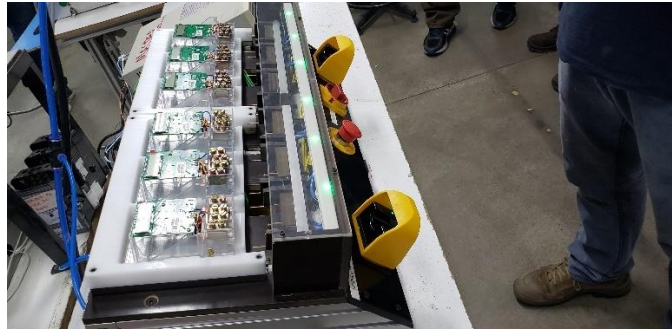
Figura 51- Visão lateral do sistema de HiPOT e conexões
