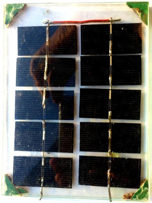
**Figura 6.4: Placa solar fotovoltaica. Produto final.**
