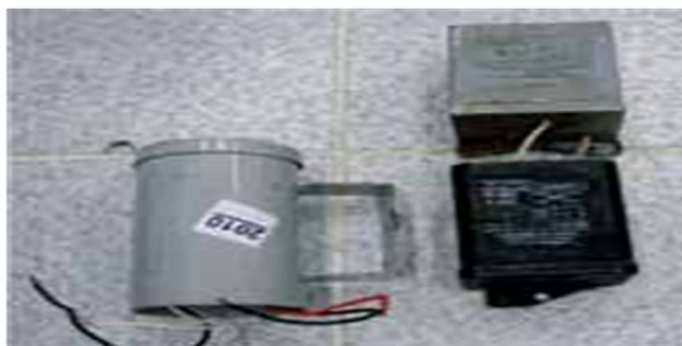
Figura 6 – Imagem de reator interno e externo para iluminação pública. Fonte: internet .
