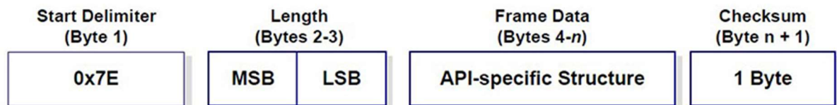
Figura 19 – Estrutura de um quadro API. Fonte Digi
