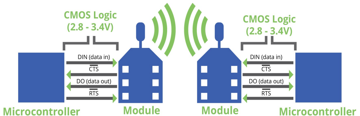
Figura 18 – Fluxo de dados UART. Fonte: Digi
