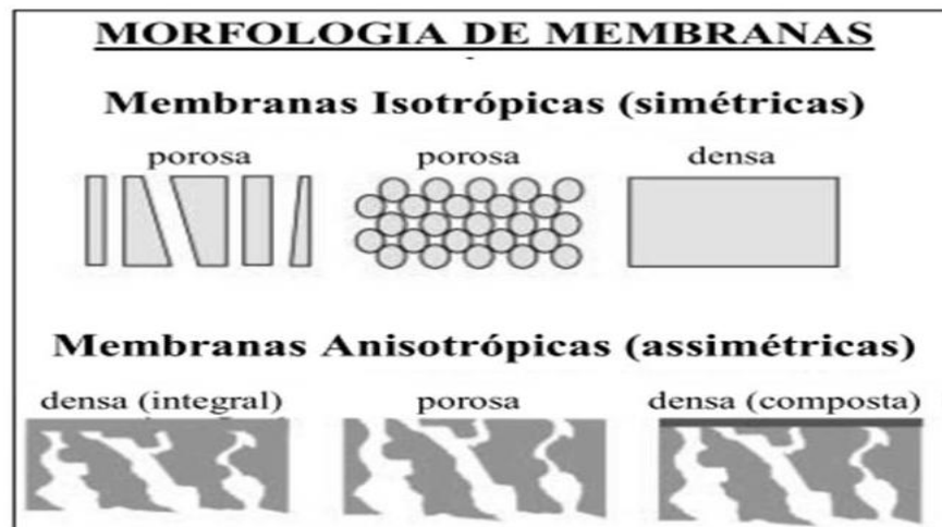
Fig. 5 – Representação esquemática dos tipos de morfologia de membranas sintéticas do PSM. Fonte: HABERT et al. (2006).
