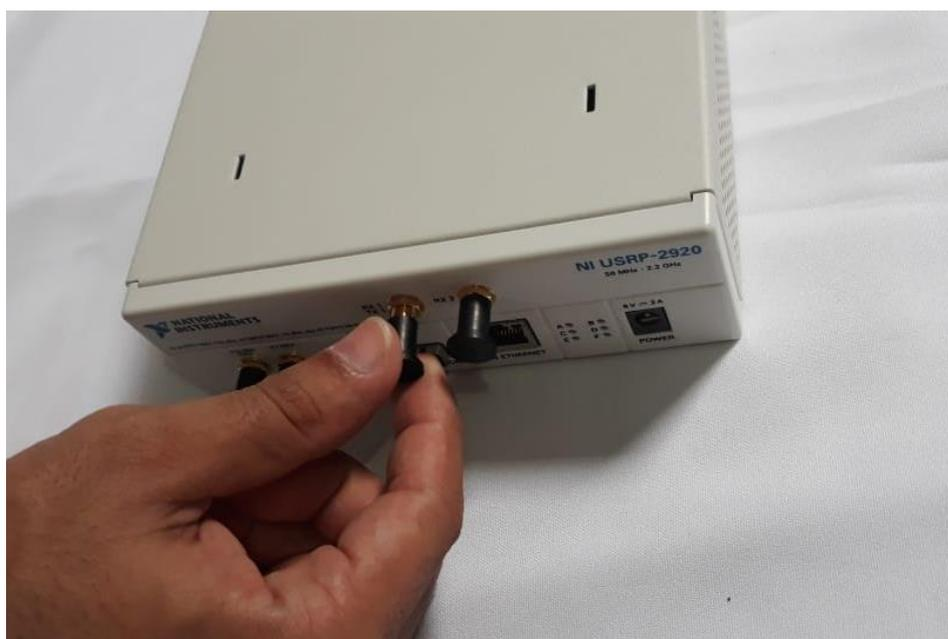
Figura 17. Tirando proteção de encaixe da antena
