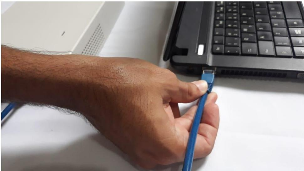
*Figura 22. Conectando cabo Ethernet no PC*
