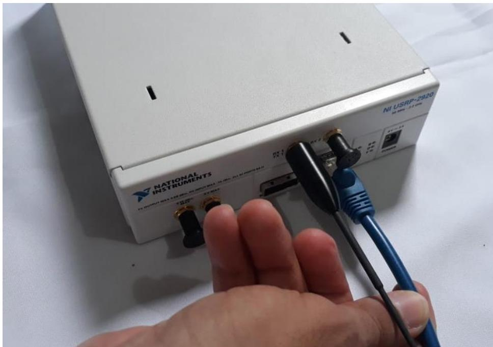
Figura 20. Conectando cabo *Ethernet* no Rádio
