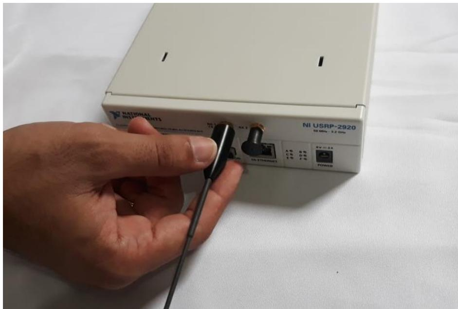
Figura 18. Conectando antena
