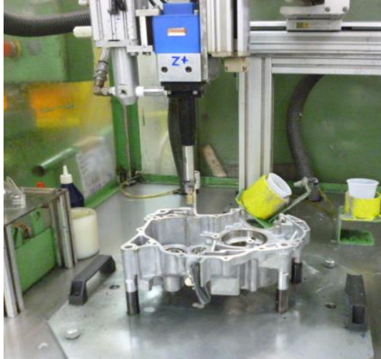
Figura 11 – Processo de aplicação de junta líquida na carcaça esquerda do motor Fonte: Acervo de ilustrações da empresa - 2017
