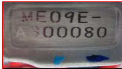
Figura 12 – Exemplo de não conformidade na gravação Fonte: Acervo de ilustrações da empresa - 2017
