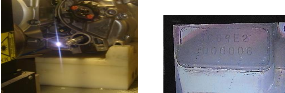
Figura 8 –Interior da máquina de gravação durante o funcionamento do feixe de laser Fonte: Acervo de ilustrações da empresa - 2018
