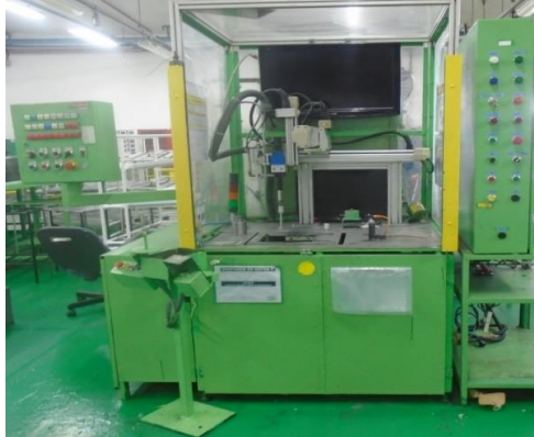
Figura 33 – Máquina de aplicação de Cola e Gravação da Carcaça Fonte: O autor - 2019
