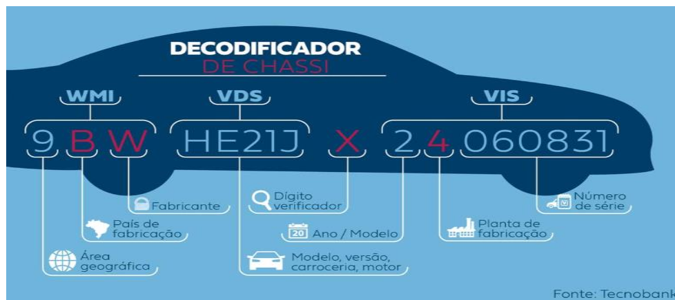
Figura 3 – Exemplo da codificação do código VIN em um veículo automotor
