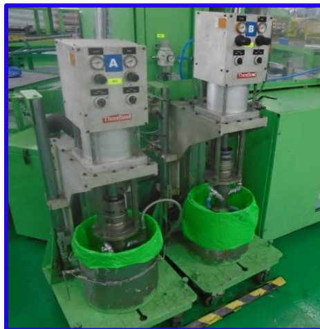
Figura 10 - Ilustração do Sistema de bombeamento de Silicone Fonte: Manual do Fabricante
