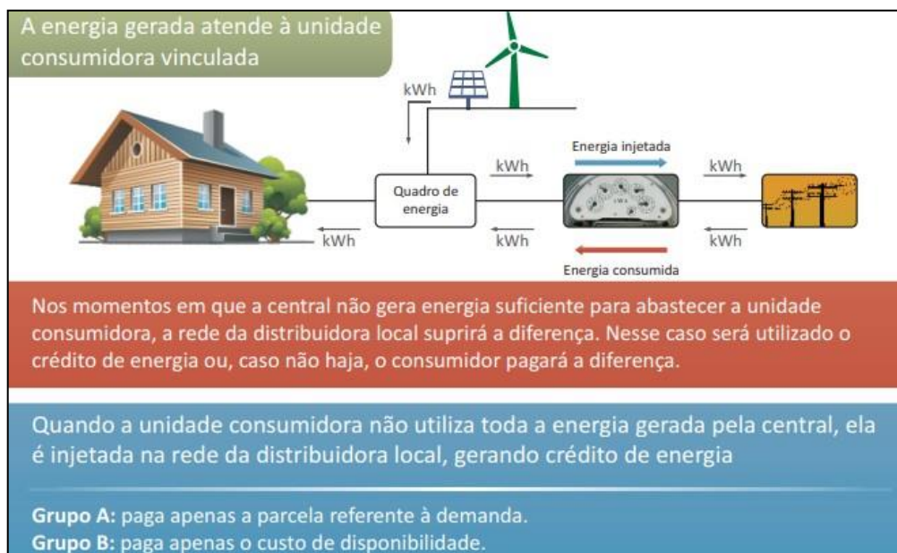
Figura 9 – Sistema de compensação de energia elétrica
