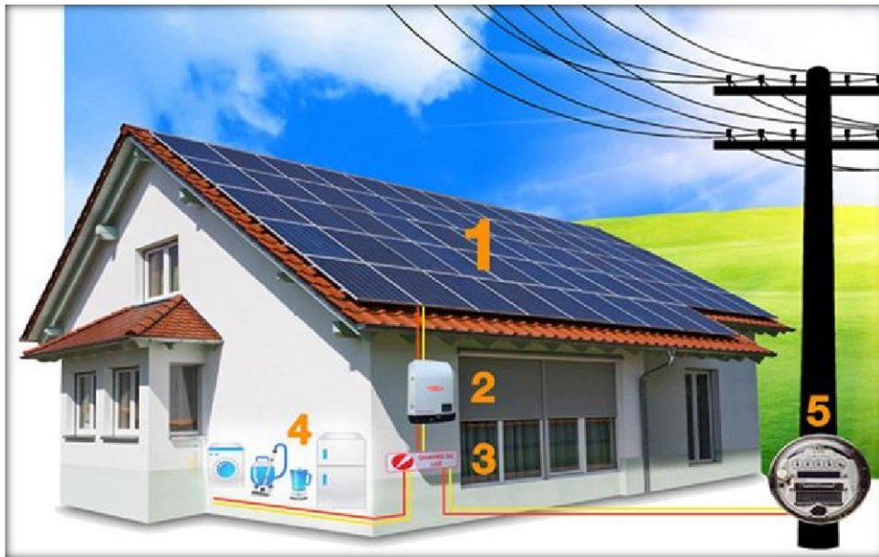
Figura 5 – Esquema de um sistema fotovoltaico On-Grid
