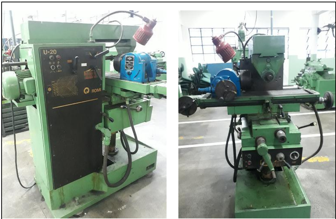
Figura 9: Fresadora Romi U-20
