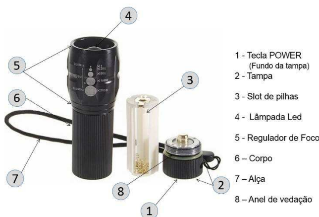
Figura 4.1 – Partes da lanterna.
