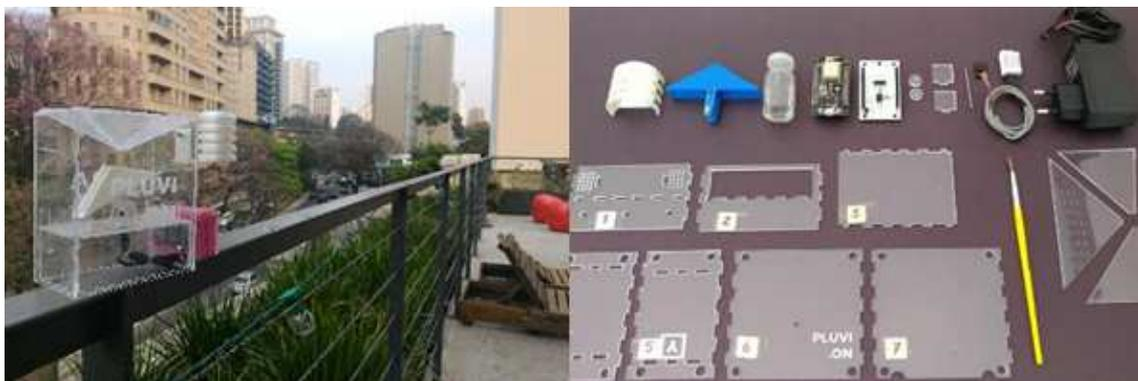
Figura 26 – Pluvi.On (a esquerda) e Peças de um Pluvi.On desmontado. Fonte: <http://www.instructables.com/id/PluviOn-Pluvi%C3%B4metro-De-Baixo-Custo/>
