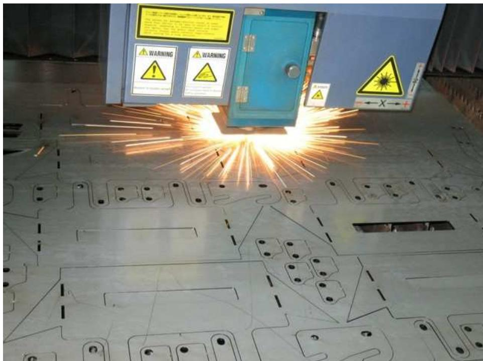
Figura 9 - Cortadora a Laser. Fonte: <http://www.lao.cz/aplikace-79/laserove-rezani-80/rezani-kovu-laserem-85>
