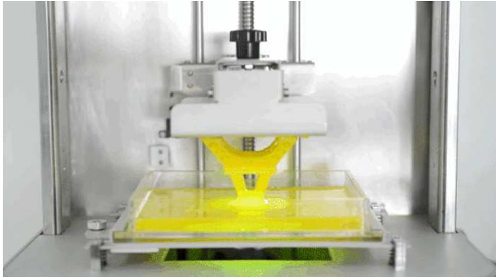
*Figura 5 - Processo de Estereolitografia. Fonte:*
