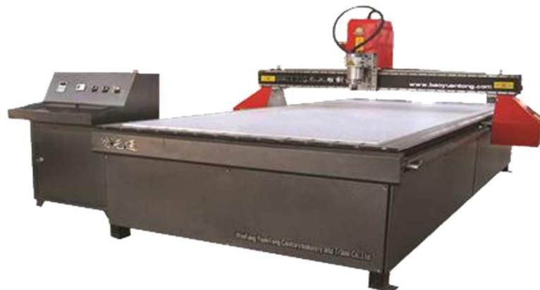
Figura 11 – Fresadora de Grande Formato. Fonte: <http://www.tecplotter.com.br/produtos/router-cnc-standart-bmg1325.php>
