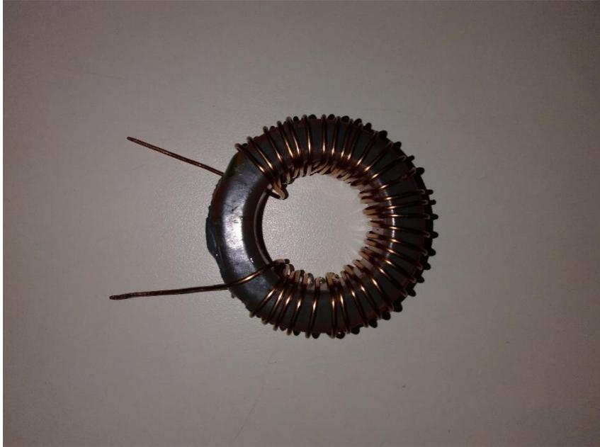
Toroidal de 22U<sub>H</sub> com núcleo de pó de ferro
