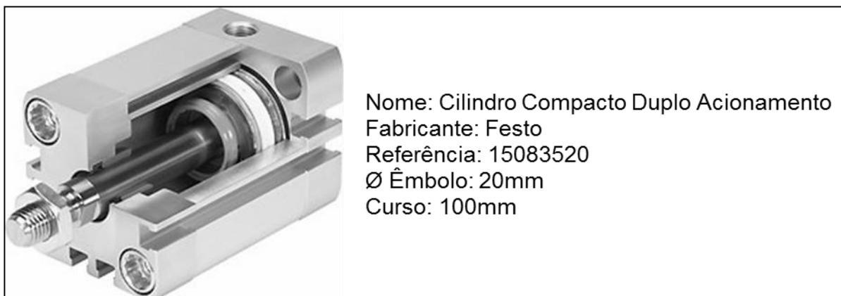
Figura 9: Especificações do Atuador Pneumático.
