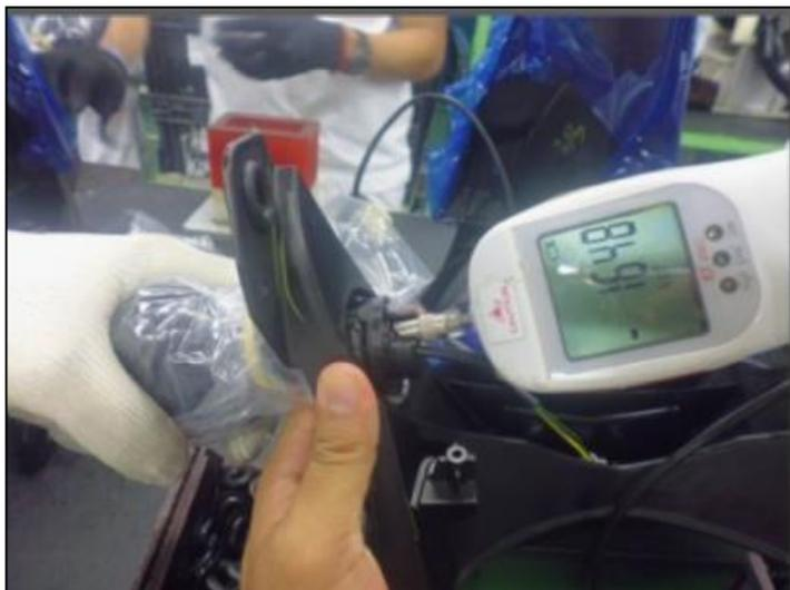
Figura 8: Utilização do Dinamômetro para Análise da Força.
