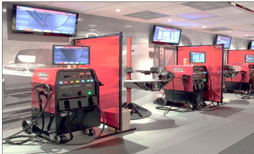
Figura 10: Instalação do Simulador de solda
