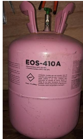
Figura 15 – cilindros com fluido refrigerante R410A
