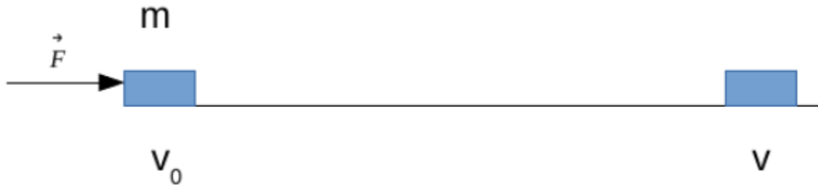
Figura 3.1.1: Representação da Aplicação de uma Força em uma partícula que se desloca de v_0 para v .
