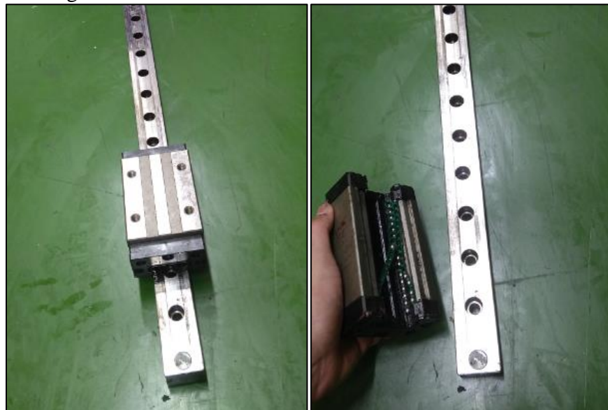
Figura 6 Guia linear e bloco deslizante danificados
