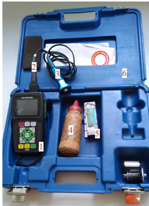
Figura 30- Aparelho de medição de espessura por ultrassom Olympus 45MG
