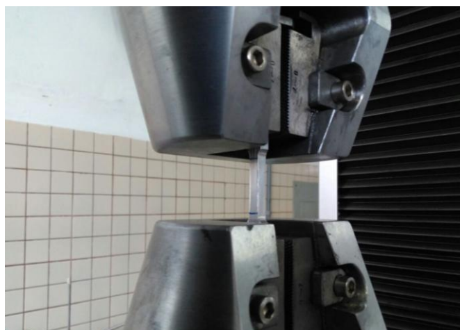
FIGURA 14 - Posicionamento do corpo de prova na máquina - Lab. Ensaio de Mat.
