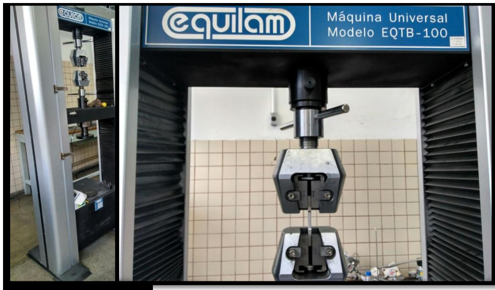
FIGURA 13 - Máquina de tração Equilam - Lab. Ensaio de Mat.
