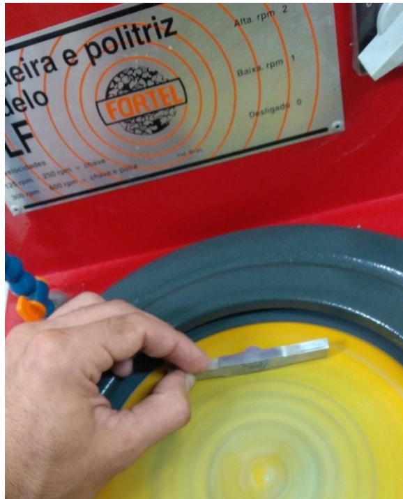
FIGURA 15 - Polimento das amostras - Lab. Metalografia
