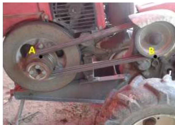
Figura 5.6 Transmissão de movimentos circulares por correia (Fonte própria)
