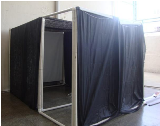
Figura 4. Estrutura com tubos de PVC coberto com TNT. Fonte: A própria autora.
