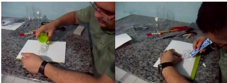
Figura 34- Montagem da lente biconvexa: teste de vazamento
