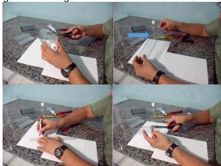
Figura 7- Montagem da lente biconvexa: faces laterais
