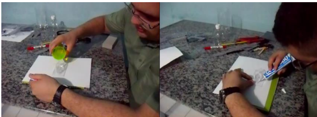
Figura 12- Montagem da lente biconvexa: teste de vazamento
