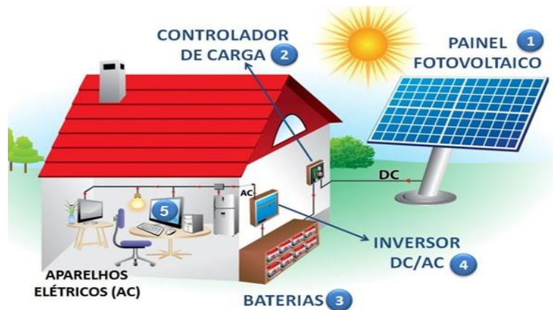
Figura 07 - Sistema Isolado ( off-grid ) com acumulador de carga
