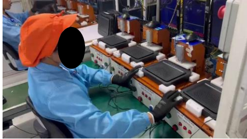
FIGURA 9. Acionamento dos botões do JIG para início do teste.
