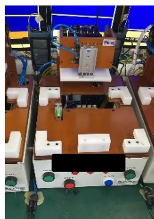
FIGURA 12. Modelo do JIG de teste após modificação
