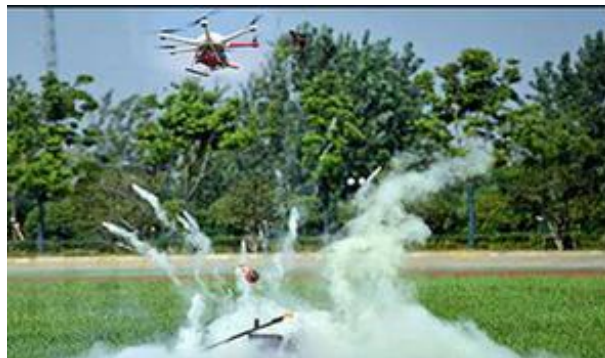
Figura 3 - Drone soltando a esfera com pó químico
