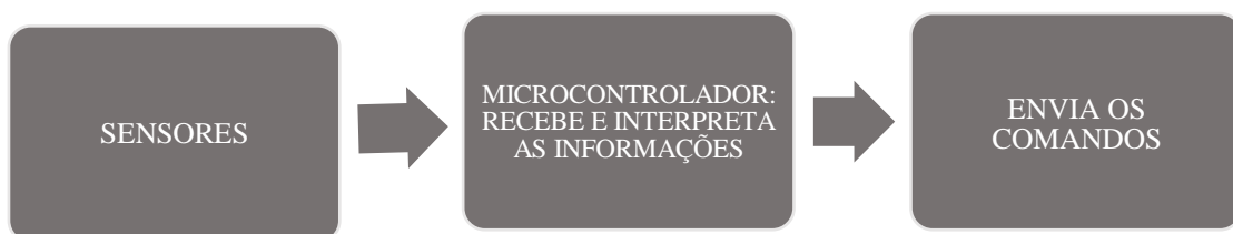
Figura 2 – Funcionamento do Microcontrolador Arduino
