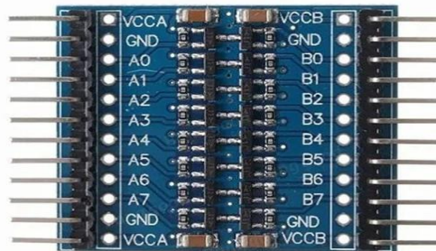
Figura 7 -Conversor de nível lógico 3,3/5V bidirecional - 8 canais (CNL8)
