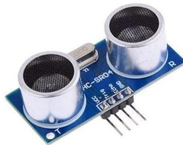
Figura 3- Sensor de Distância Ultrassônico HC-SR04.
