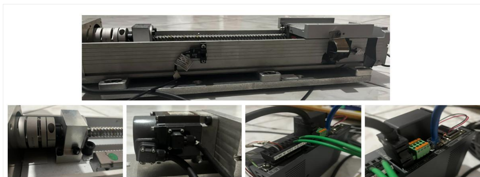
Figura 16 - Montagem final e conexões do atuador
