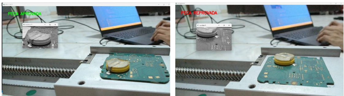
Figura 46 – Resultados de inspeção da bateria gerado pelo sistema
