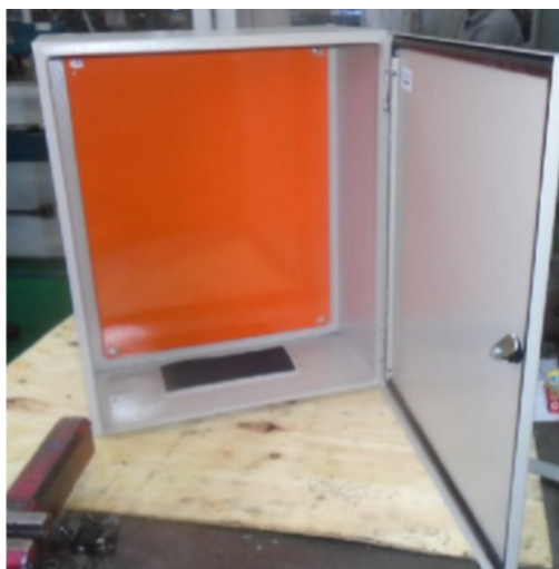
Figura 21 – Confeção do Painel elétrico
