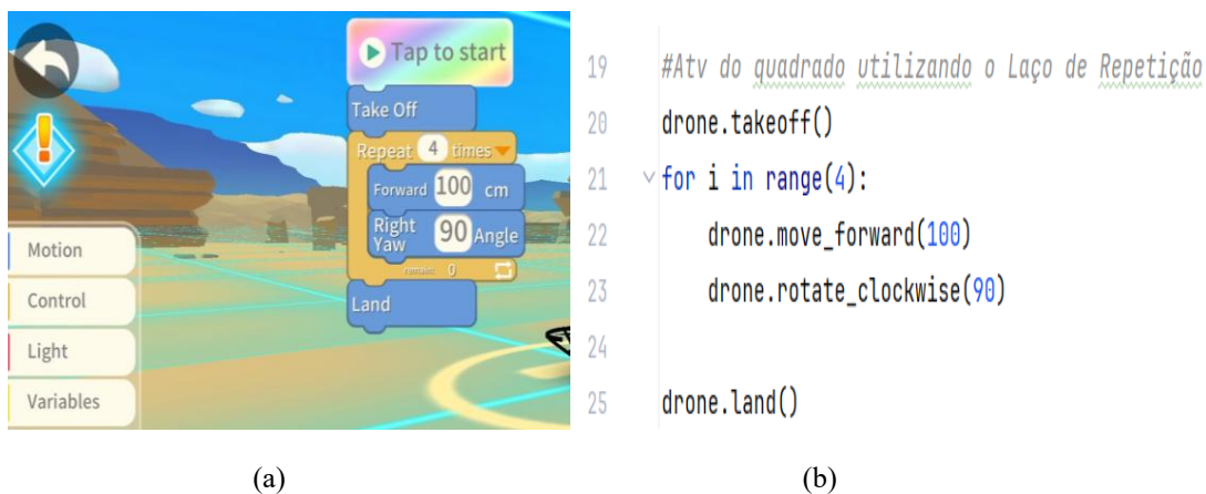
FIGURA 17 - (a) Programação em blocos com laço de Repetição (b) Programação em Python com Laço de Repetição
