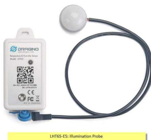
Figura 47: Dragino LHT65 com sensor de luminosidade externo
