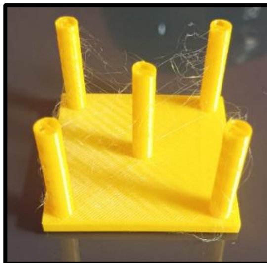
Figura 36 - Impresso em ABS após secagem de 8 horas.
