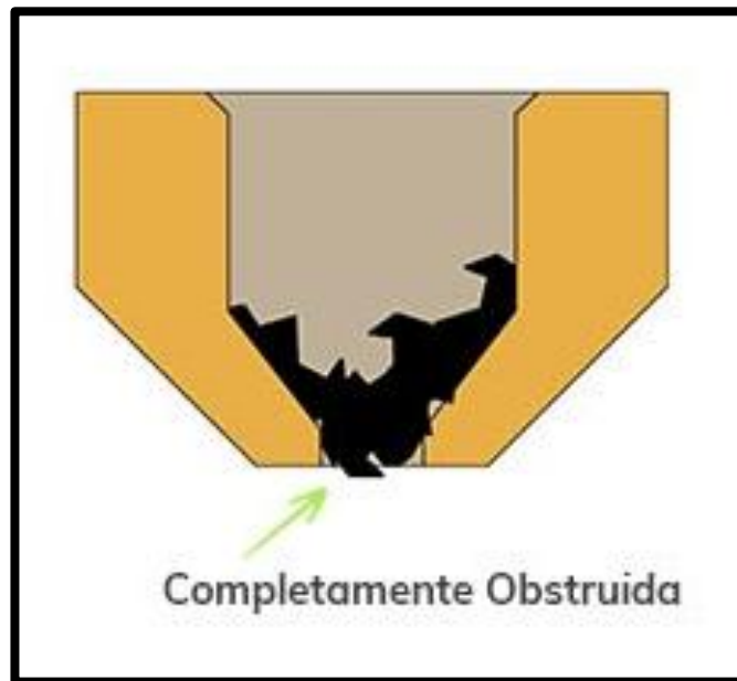
Figura 5 - Entupimento de bico.
