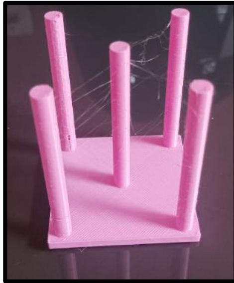
Figura 35 - Impresso em PLA após secagem de 8 horas.
