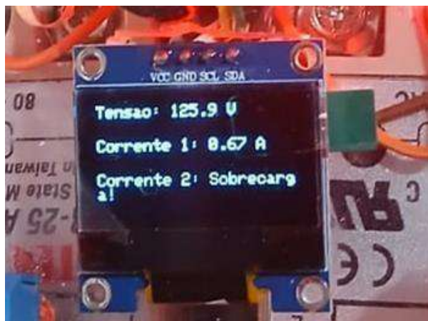
Figura 13: Mensagem de Sobrecarga em evidencia no display.
