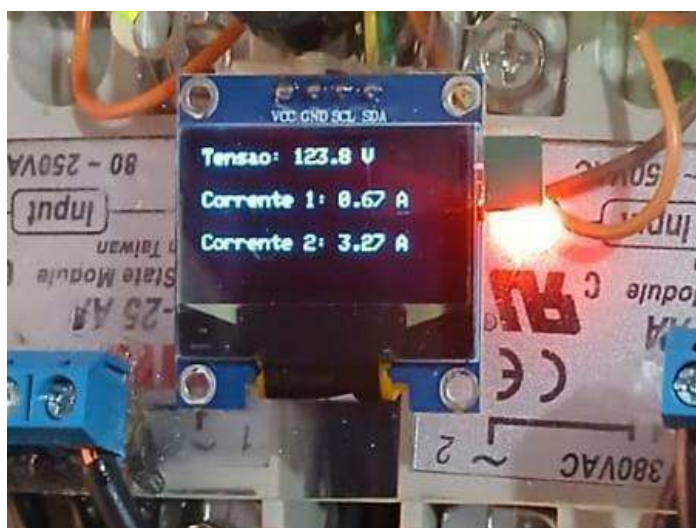
Figura 11: Valores medidos de tensão e corrente dos circuitos.
