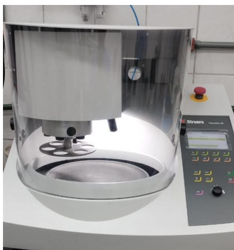
Figura 7 – Máquina que realiza lixamento e polimento da engrenagem
