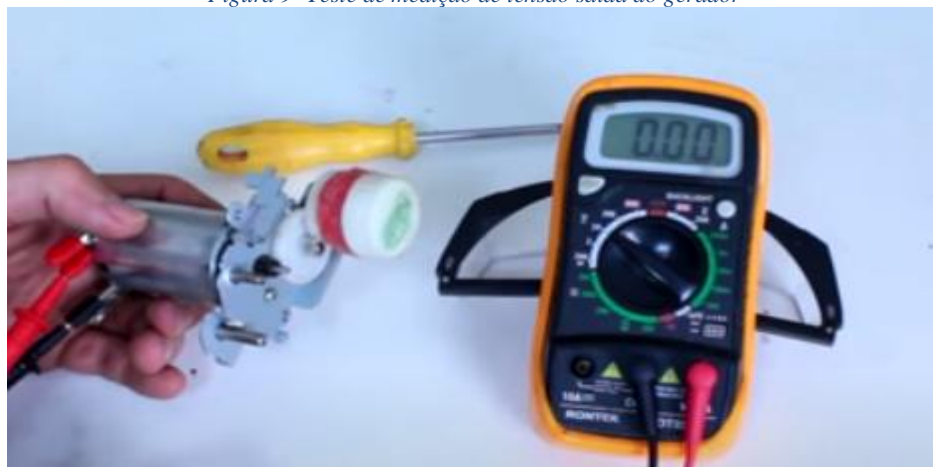
Figura 9- Teste de medição de tensão saída do gerador
