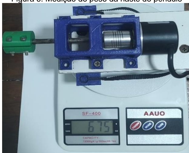
Figura 6. Medição do peso da haste do pêndulo
