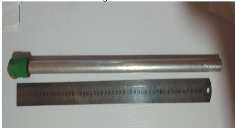
Figura 9. Utilização da régua para medição do comprimento da haste do pêndulo do pivô ao centro de gravidade
