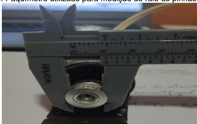
Figura 5. Paquímetro utilizado para medição do raio do pinhão do motor
