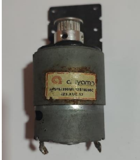
Figura 8. Micro motor DC utilizado para medições de seus parâmetros
